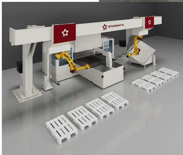
per esempio quando la produzione richiede pezzi unici o prototipazione. Al tempo stesso, con il funzionamento automatico, i due robot integrati gestiscono lamiere di varie dimensioni, in linea con le capacità della pannellatrice: le dimensioni sono comprese tra 200 x 400 mm e 2.163 x 1.500 mm, con spessore accettato fino a 3 mm per acciaio, 2,2 mm per inox e fino a 4 mm per alluminio, per un peso che può raggiungere i 75 kg.
